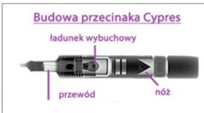
Zdjęcie RTG przecinaka firmy Cypres
