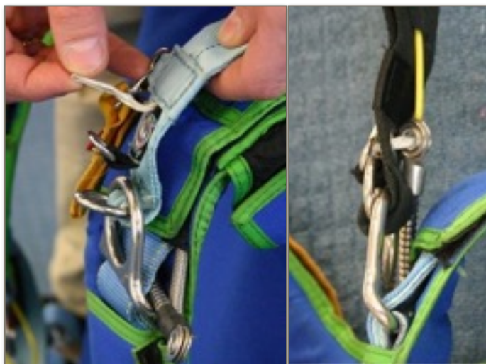
Zamki taśm nośnych spadochronu głównego
