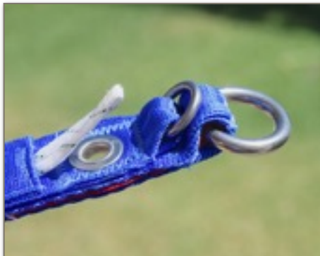
Wąska taśma nośna jest bardziej podatna na usztywnianie się podczas eksploatacji niż szeroka
